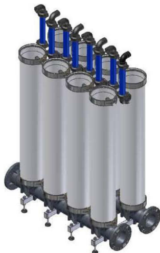
شکل ۱۱-۱۲: مونتاژ کوپلینگ لوله فوقانی
