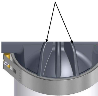
شکل ۱۱-۱۳: شیارهای برجسته بر روی لوله‌ی اصلی جریان خوراک/تخلیه
