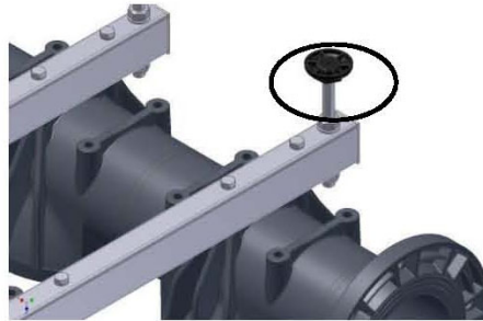
شکل ۶-۱۱: اتصال پایه‌های قابل تنظیم
