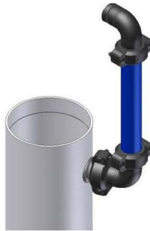
شکل ۱۰-۱۱: لوله شفاف آب فیلتر شده با کوپلینگ‌های قابل تغییر ۲ اینچی
