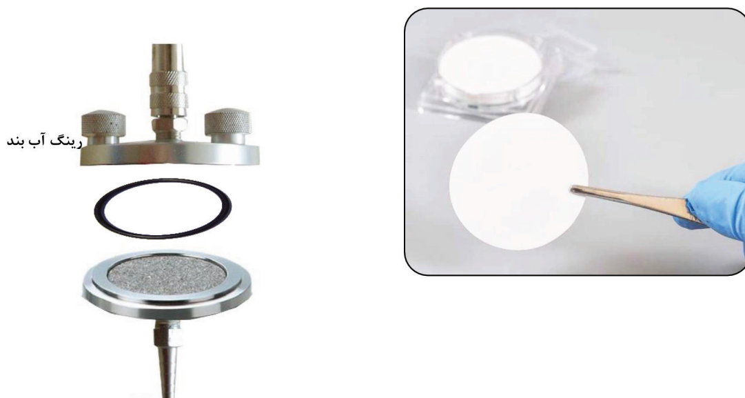
شکل ۴- جاگذاری صافی 0,45 میکرومتر در محفظه فیلتر
