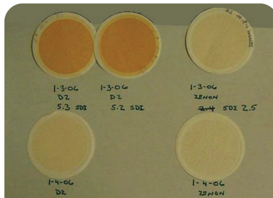
شکل ۶- نمونه صافی‌های ۰٫۴۵ میکرومتر بعد از آزمایش SDI
